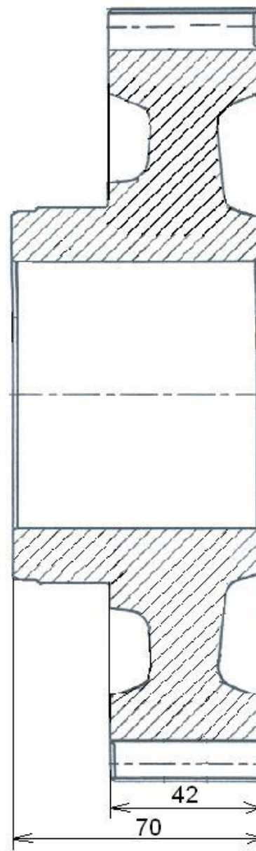
Рис. 2. Шестерня 2-ой передачи 1509.1701050
