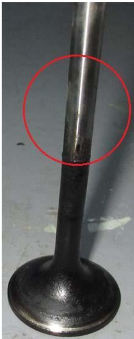
Рис. 3. Клапан выпускной с отложениями на стержне клапана, характерными для использования несоответствующего топлива
