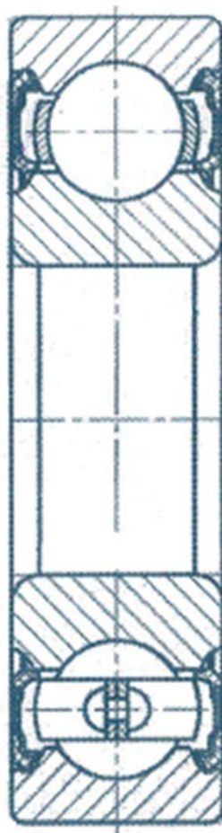
Рис.1. Подшипник шариковый радиальный однорядный с двумя контактными уплотнениями («закрытый»).
